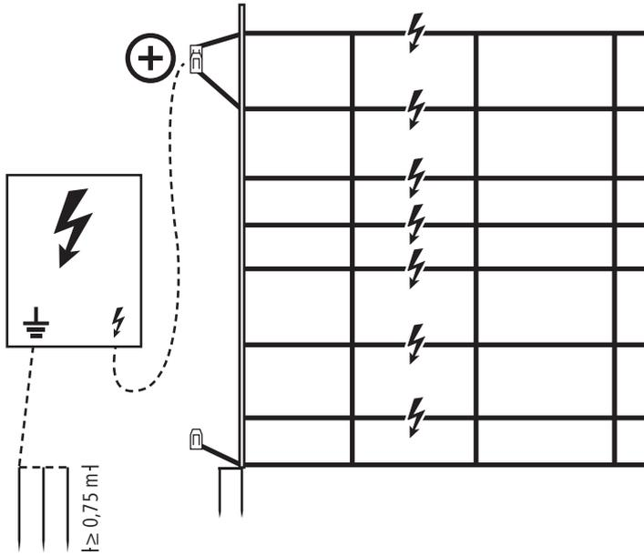
PLUS Netz mit Bodenlitze Erdung | Filet PLUS avec mise à la terre du toron inférieur
